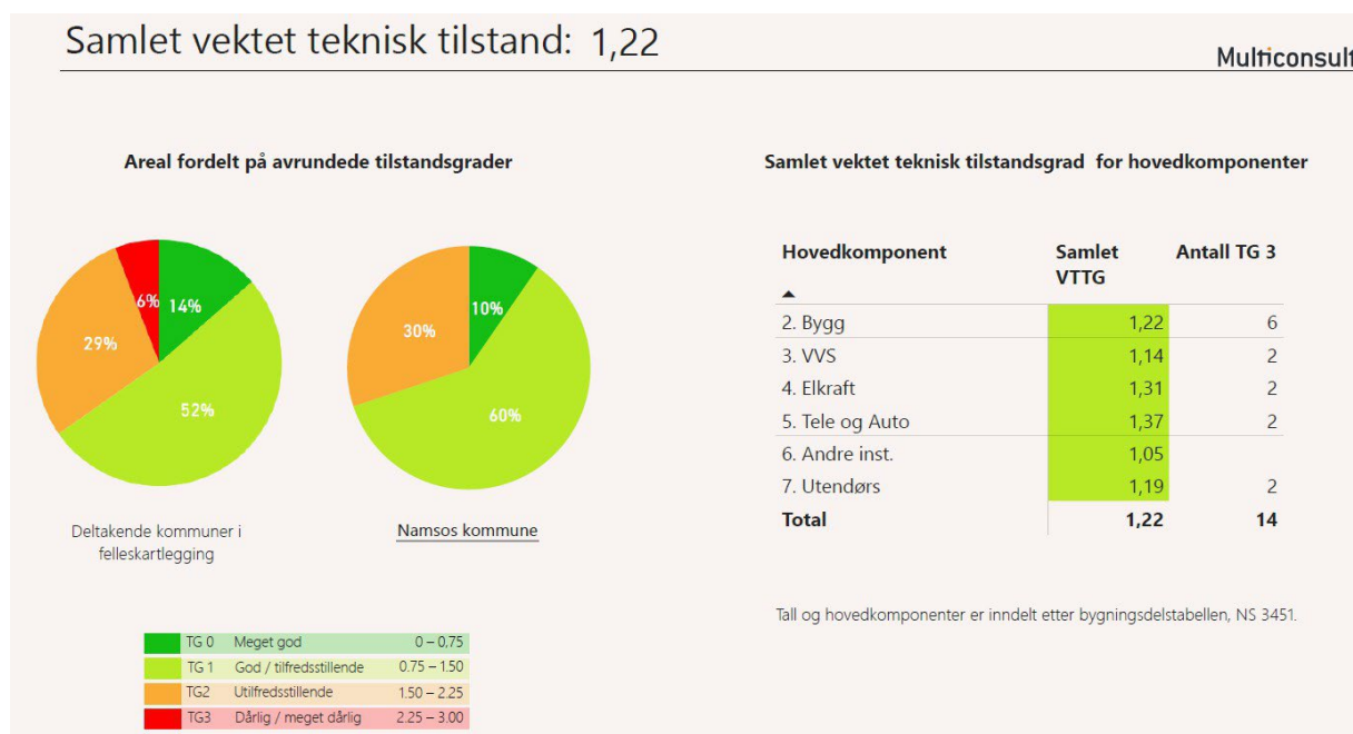
Figur 1. Oversikt tilstandsgrad på bygningsmasse. Kilde: Namsos kommune / Multiconsult.
