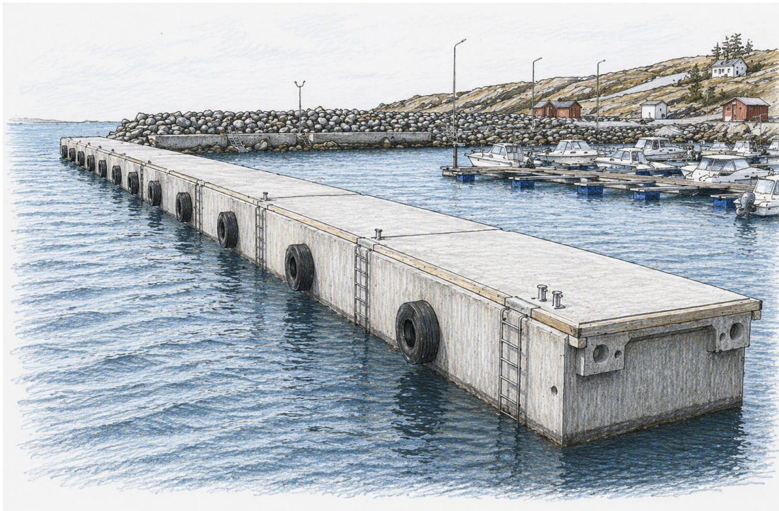
Figur 1. Illustrasjonsbilde av en betong-flytebrygge
